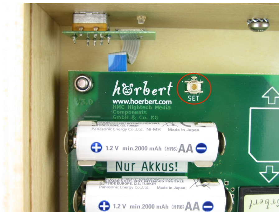
Figure 54 - hörbert 3.0 de l'intérieur - Bouton SET
