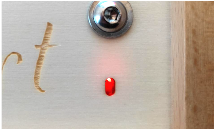
Abbildung 8 - Mikrofon-LED leuchtet rot bei Aufnahme
