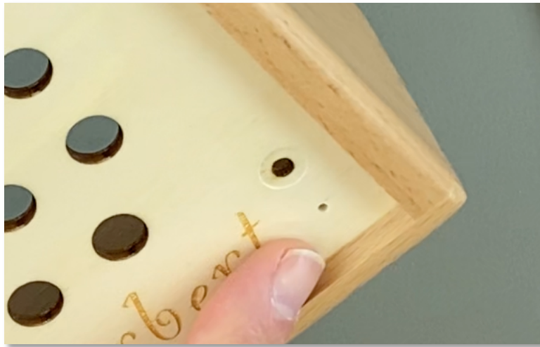
Abbildung 4 - Bohrloch für Mikrofon-LED-Anzeige
