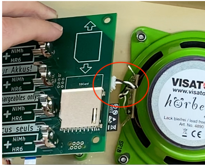
Abbildung 13 - Steckverbinder für das Lautsprecherkabel
