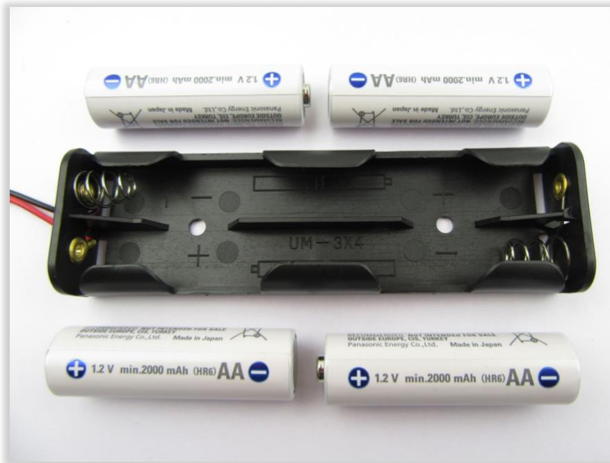
Figure 3 : compartiment de charge de la batterie : polarisation des batteries
