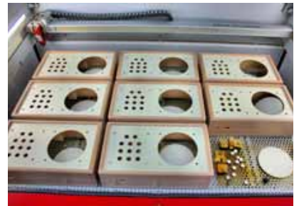
Mittels einer Lasergraviermaschine werden in jedes Gehäuse die Beschriftungen unveränderbar eingebracht. Auf diese Weise ist jedes Gerät individualisierbar.
