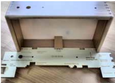
Das Gehäuse des Hörbert wird extern produziert. Die Chargen werden mittels einer ausgefeilten Lehre auf Maßhaltigkeit geprüft.
