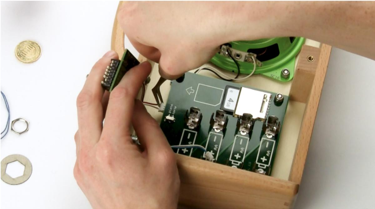
9. Stecken Sie zuletzt das übrige blau-weiße Kabel des Lautstärkereglers in die freie Buchse der Zusatz-Elektronik ein. Damit ist die neue Verkabelung erledigt.
