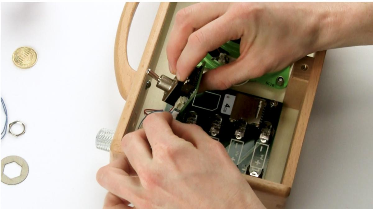
10. Im Folgenden Schritt führen Sie den Schalter der Zusatz-Elektronik wieder durch die Öffnung im Gehäuse. Die kleinen weißen Schalter (das „Mäuseklavier“) zeigt dabei nach oben, sodass Sie es später bequem bedienen können.
