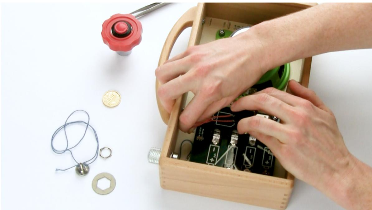
6. Stecken Sie nun auf gleiche Weise das blau-weiße Kabel des eingebauten Lautstärkereglers aus der hörbert-Elektronik aus. Lassen Sie den Lautstärkereglер aber im Gehäuse verschraubt.
