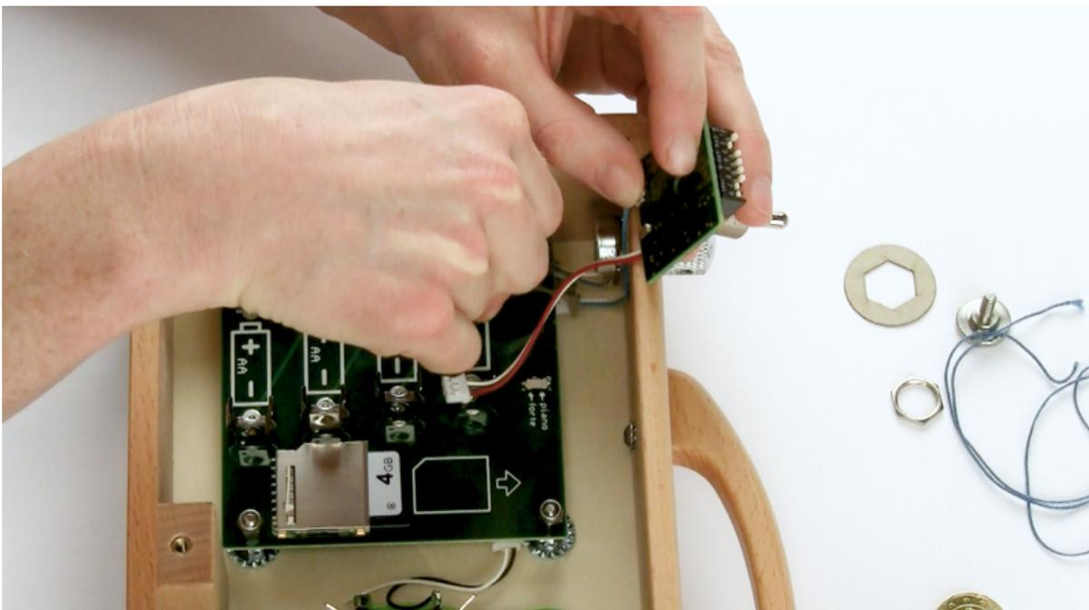
8. Stecken Sie das rot-weiße Kabel der Zusatz-Elektronik in die Buchse, in der vorhin der Ein/Ausschalter steckte. Auch er ist von oben sichtbar und mit einer Pinzette gut zu treffen.
