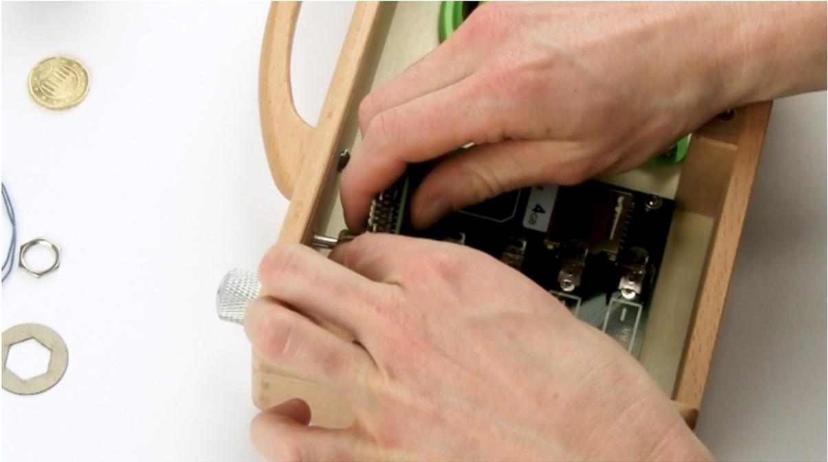
11. Unter Zuhilfenahme des Kratzschutzes ziehen Sie nun die Mutter des Schalters wieder handfest an. Verwenden Sie nicht zu viel Kraft, um das Gewinde nicht auszureißen.
